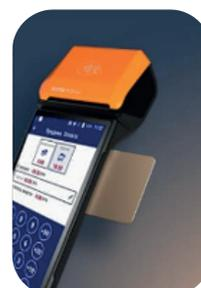
Для использования бесконтактных карт приложите к считывателю бесконтактных карт. Для совершения операции нужно поднести пластик к устройству. Контакт устанавливается на расстоянии в несколько миллиметров, максимум 10 сантиметров. Для использования карт с чипом, необходимо ставить карту в считыватель чиповых карт.
